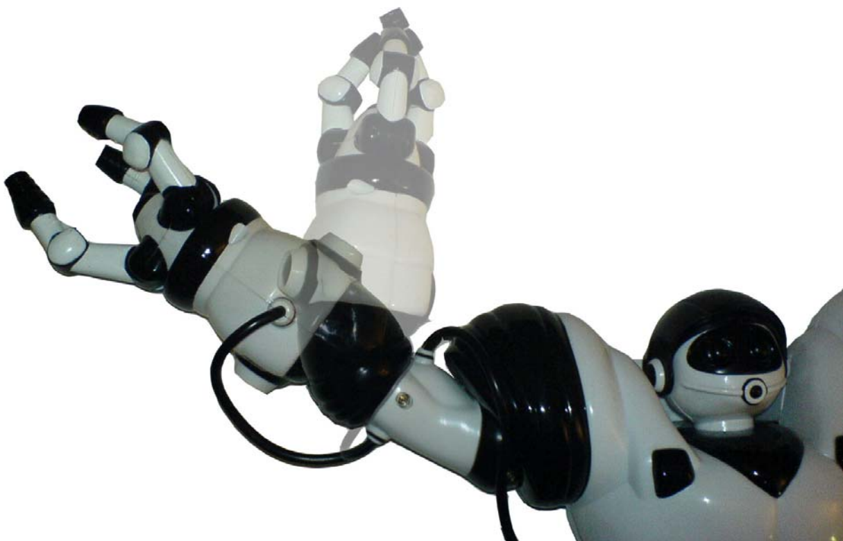
Abbildung 7: Ablauf des Schließens einer Hand mit Verlagerung der Handposition
