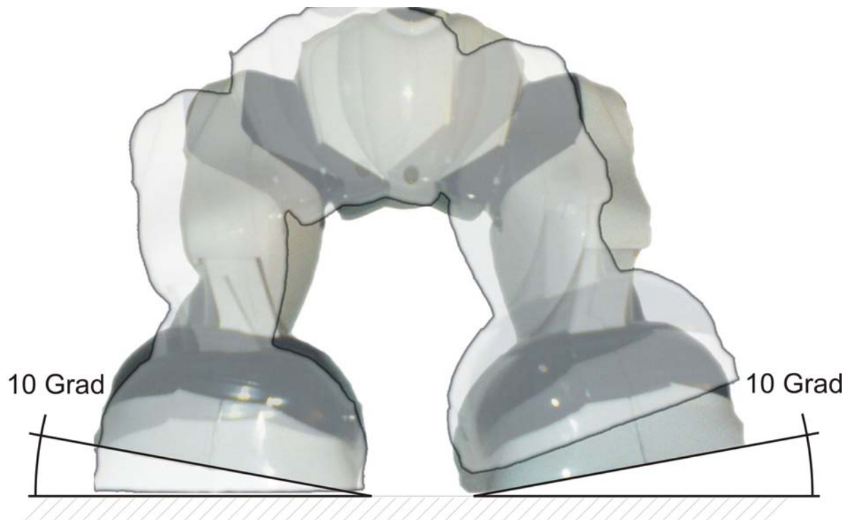
Abbildung 6: Prinzip eines Schrittes mit dem Rechten Fuß durch Gewichtsverlagerung auf den Linken
