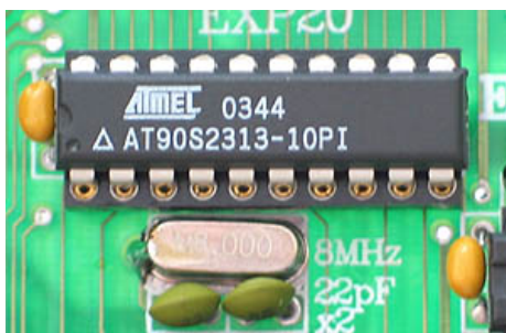
Abbildung 25: 20-Pin Sockel des AVR Programmierboards mit aufgestecktem AT90S2313 Mikrocontroller
